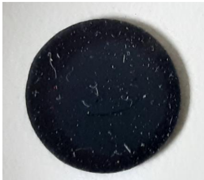
Si-Filter, stark beladen
